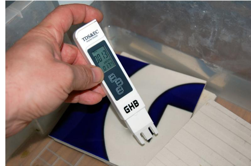
Medición de la conductividad del agua para determinar la presencia de sales solubles durante el proceso de desalación de los azulejos.
